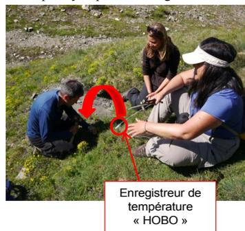
3: Déposez l'enregistreur au fond du trou et prenez les coordonnées GPS de ce trou.
