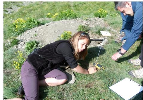
Figure 11: Déroulement de la mise en place des enregistreurs de température. Lorsque le trou n'est pas déjà fait référez-vous aux étapes 1, 2 et 3 de la figure. Si celui-ci est déjà fait suivez uniquement les étapes 2 et 3 de la figure.
